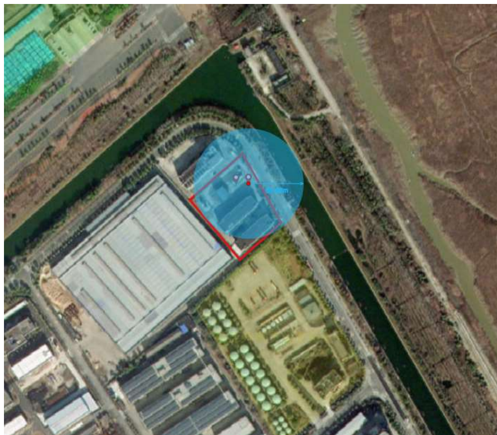
附图 2.2-9 液氨槽罐车-装卸臂完全破裂—喷射火灾—常压容器的模拟图
